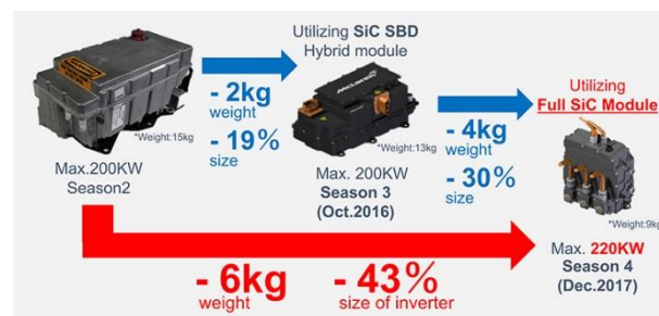
図 1-3 WBG 半導体デバイス適用時における電源回路の小型化例[9]
